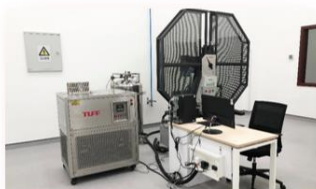
750J冲击试验机 测量材料的冲击韧性值和抗冲击能力
