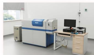
直读光谱分析仪 金属成份的快速定量分析
