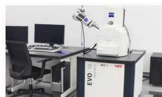
扫描电子显微镜 可对各种材料表面作分析
